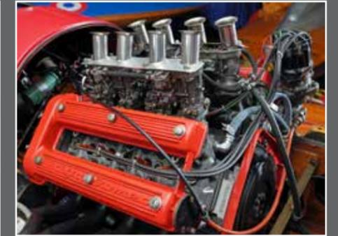
On remarque la finesse des extrémités relevées en pointe du tableau arrière aux lignes sinueuses, une marque de fabrique du chantier vénitien Dino Celli. Le cockpit est celui d'une vraie bête de course, accélérateur à droite et cale-pied à gauche, arbre d'hélice entraîné directement en sortie du V8 Alfa Romeo Montreal spécial de 3 litres, avec 250 ch à maîtriser pour approcher les 200 km/h.
